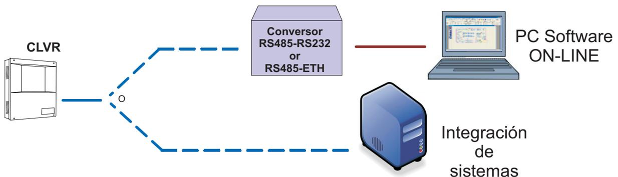
Ejemplo de conexionado para funcionalidad MODBUS
